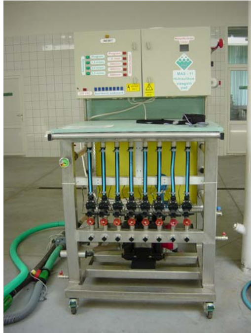
Hidraulikus vizsgálópád szabályzó berendezések vizsgálatához
