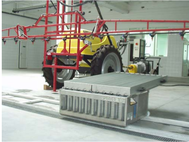
Mobil kivitelű, számítógép-vezérlésű ultrahangos vályúsor a keresztirányú szórás egyenletesség meghatározásához
